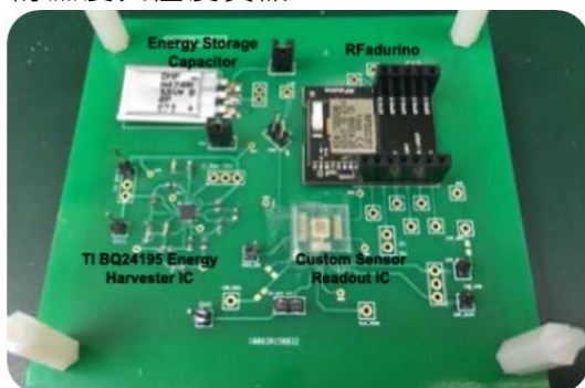
圖 19 自供電之環境監測(溫濕度)系統板
